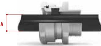
Kabeldurchführung mit Gummidichtung mit nicht armiertem Kabel
